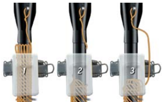
Se recomienda doble soporte del neutro concéntrico (ver ejemplo #1 en el gráfico de arriba). Los ejemplos 2 y 3 indican otros métodos de prácticas del neutro aceptables.
